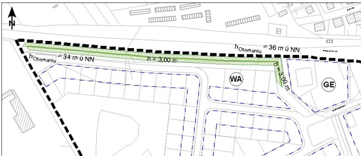
Bild 5.1: Lärmschutzwall  $h=3,00$  m und  $L=390$  m
